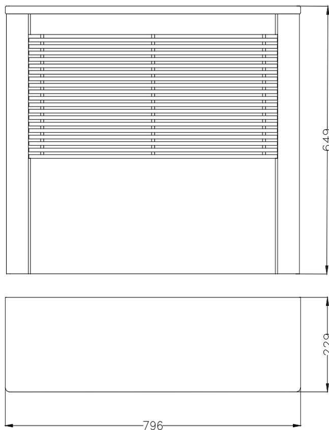
Il mobiletto va fissato alla parete, ad una altezza consigliata di 15-20 cm dal pavimento. Per il fissaggio vanno utilizzati i fori  $\varnothing=5\text{mm}$  presenti sulle quattro squadrette metalliche all'interno della cornice.
