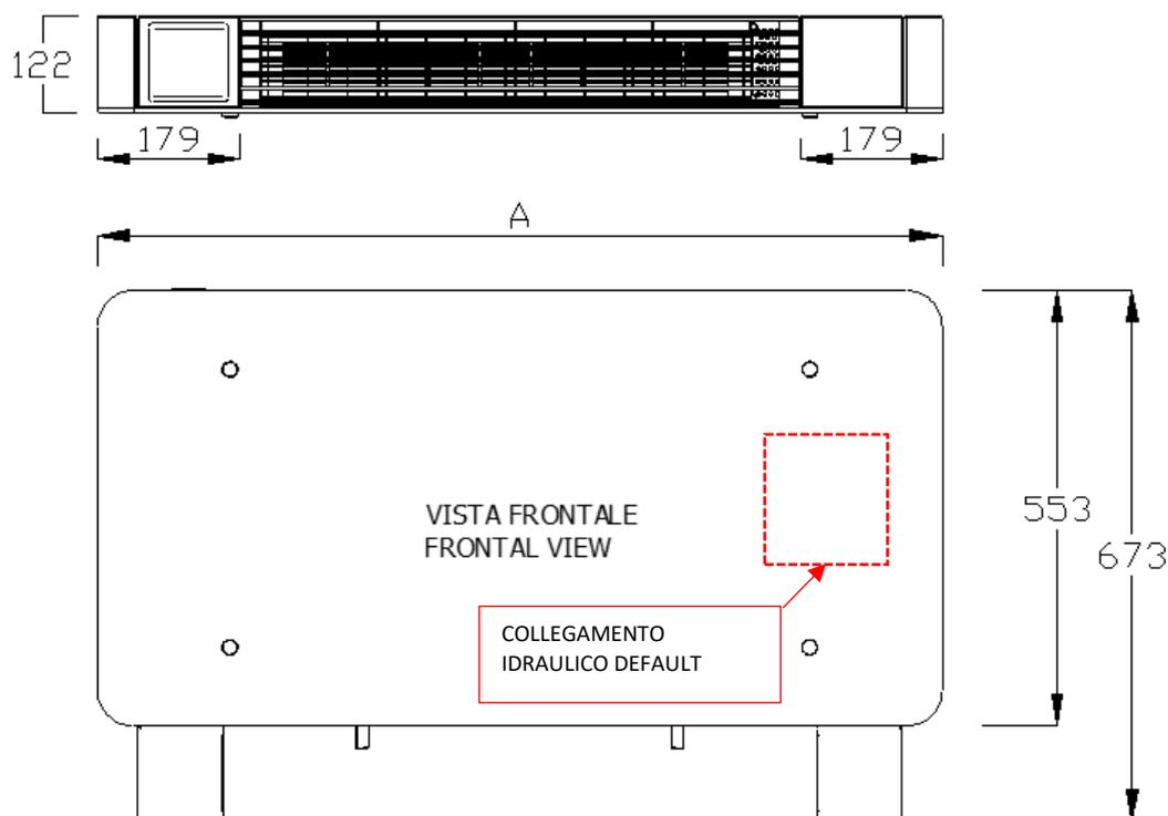
Il ventilconvettore viene fornito con connessioni idrauliche lato DESTRO; è possibile invertire l'attacco in SINISTRO con operazioni riportate meò manuale uso/inst.
