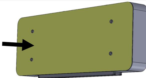
Riposizionare le viti nella sequenza dell'immagine a fianco. Riposizionare la vite in plastica in corrispondenza dello scarico condensa.
